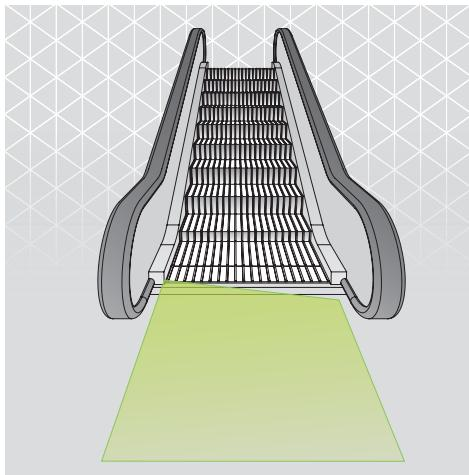
**Figure 1:** Le TOF/Start détecte les personnes qui s'approchent d'un escalator.
