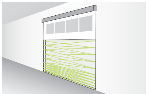
Abb 4: Schnellaufotor mit Torausblendung
