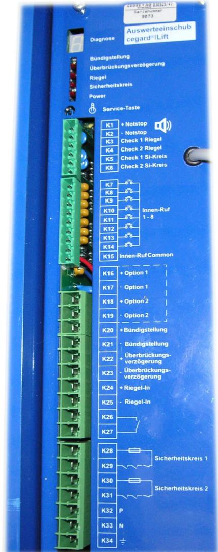
Abb 10: Anschlussklemmen Auswerteeinschub
