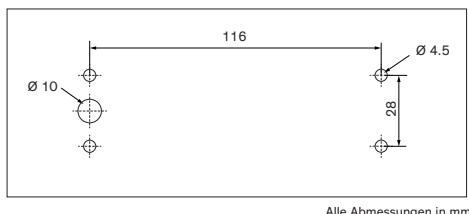
**Abb 8:** Rückseite TPS in Aufputzmontage
