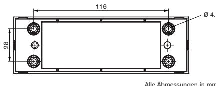
**Abb 7:** Rückseite TPS in Unterputzmontage
