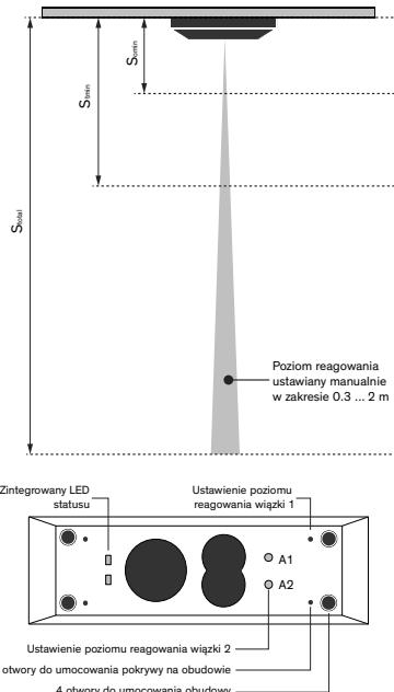
Rys. 4: Zasięg działania i poziomy reagowania urządzenia
