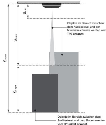
**Abb 5:** Beispiel für das Auslösen des TPS-Sensors
