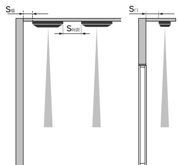
图 6: TPS间距的正面视图 (左) 及侧面视图 (右)
